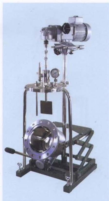
Реактор может быть быстро опорожнен и промыт
