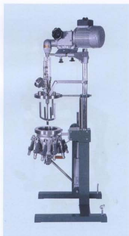
Реактор может быть разобран для чистки
